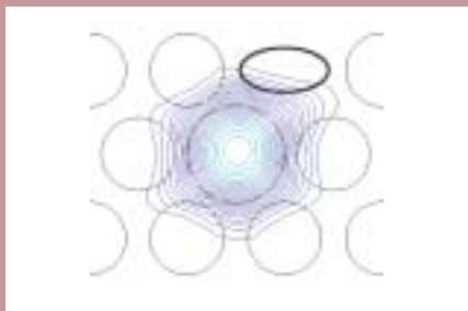
Figure 2. Distribution modale du champ électrique du mode fondamental pour une structure déformée.
